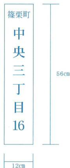
図2 街区表示板（緑色）
